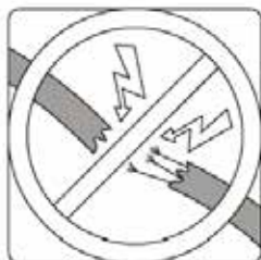
Auf beschädigte Drähte überprüfen
