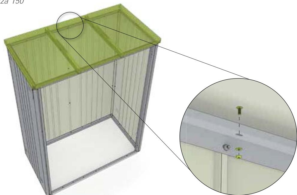
Size-Dependent assembly step - Paso de montaje de tamaño Dependiente - Taglia-Dependente fase di montaggio
