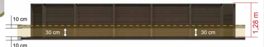
Pour l'installation de la piscine Naturalis, il est nécessaire de réaliser une dalle de fond en béton de plus de 10 cm par rapport aux dimensions de la piscine.
