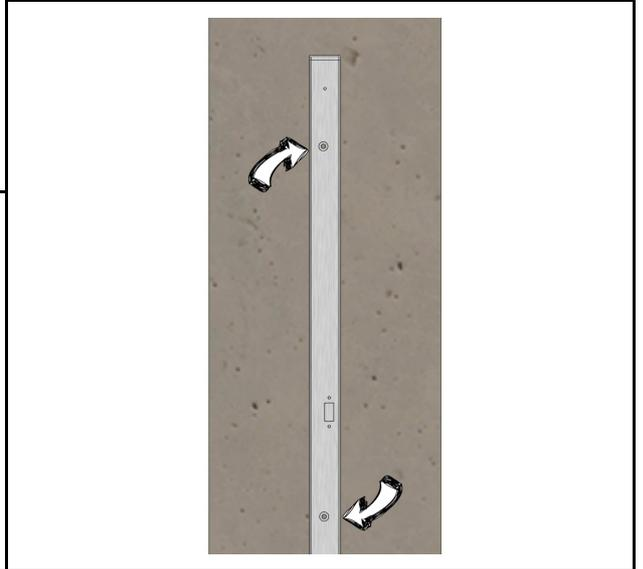
Retirez la battue du profil de réception grâce aux vis M5x10. Positionnez-le sur les repères précédemment réalisés, percez dans les trous Ø16, fixez le profil puis remontez la battue.
