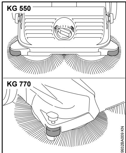
El rodillo lateral facilita la conducción de la máquina en la zona del borde, p. ej. a lo largo de paredes o bordillos.
