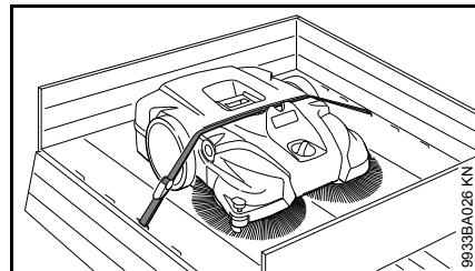
固定ストラップを使用して、機械が滑らないよう固定します。
