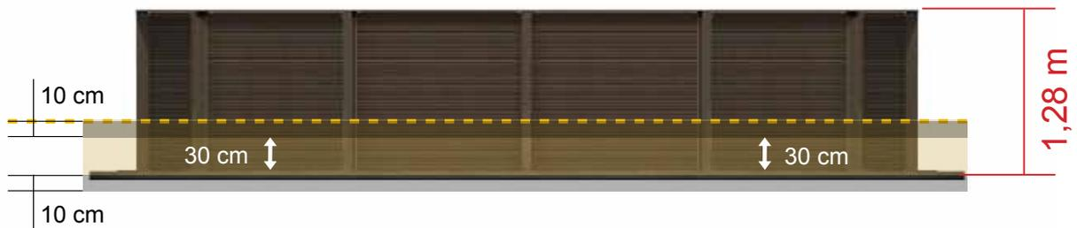
En suite, effectuer le remblai au même temps que le remplissage de la piscine. Vous devez laisser 10 cm pour une dalle de propreté au niveau de la margelle
