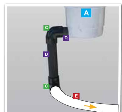
Pour effectuer le raccordement du skimfiltre, découpez un bout de tube PVC rigide d'environ 7 cm pour raccorder la sortie du skimniltre au coude 90°.
