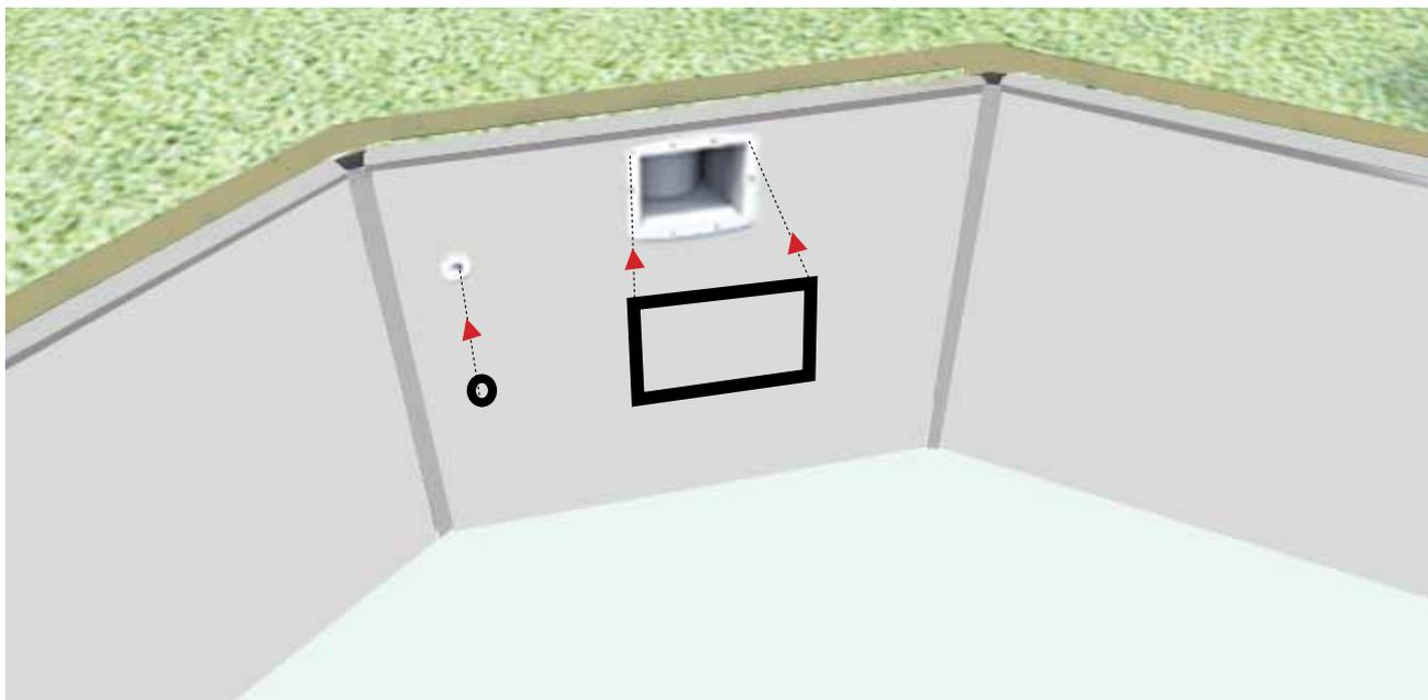
Vérifier que les trous des joints sont correctement positionnés avec le skimfiltre et le refoulement.
