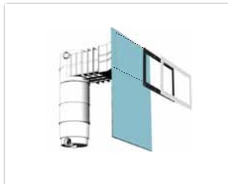
Ensuite, superposez le joint et la bride des accessoires et réalisez la première perforation, en vissant la première vis. Une fois la deuxième vis placée, toutes les autres se trouveront dans la position correcte.
