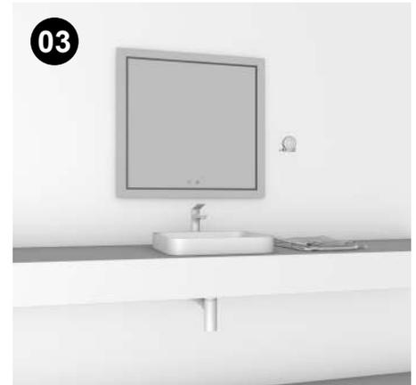
**03** Placer le miroir dans la position souhaitée et marquer et identifier les points d'ancrage.
