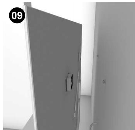
09 Si le câble d'alimentation du miroir est trop long, vous pouvez le maintenir au mur avec du ruban de masquage en faisant une large boucle, assurez-vous également que ce câble ne sera pas en tension ou pincer lorsque le miroir sera sur ses supports qu'il n'empêche pas de plaquer le miroir au mur.
