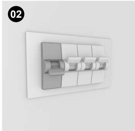
**02** Couper le raccordement électrique dans la zone où vous allez installer le miroir, vérifier le niveau de tension par sécurité.
