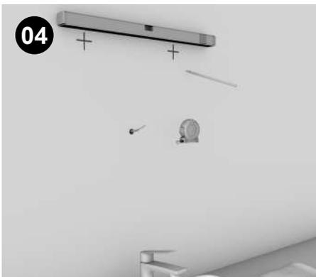
**04** Les miroirs lumineux sont fixés au mur par de simple vis. Consulter les supports de montage à l'arrière du miroir, marquer la position des trous pour les vis de fixation dans le mur, vérifier l'horizontalité du pré-perçage avec un niveau à bulle, assurez-vous de l'alignement avec le centre du lavabo ou de la vasque, afin que le miroir soit centré.
