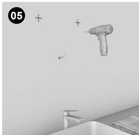
**05** Une fois le contrôle effectué, percer le mur (ne pas utiliser de marteau perforateur sur du carrelage pour ne pas faire éclater le carreau). Percer deux trous Ø 8 - 40 mm.
