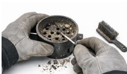
FIGURE 4 – Creuset obstrué par du mâchefer
