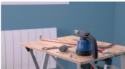
Pour raccorder les tubes aux raccords cuivre, nous allons réaliser une brasure tendre, c'est-à-dire une brasure à basse température inférieure à 450°C.
