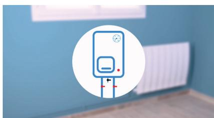
Avant toute intervention sur le réseau de chauffage central, éteignez la chaudière et fermez les vannes de départ et de retour à la chaudière.
