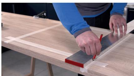
Afin de limiter les éclats lors de la coupe, reliez les angles avec de l'adhésif de masquage. Puis tracez les lignes de coupe avec une règle de maçon. Vérifiez que rien ne fera obstacle au passage de la lame sous le plan de travail.
