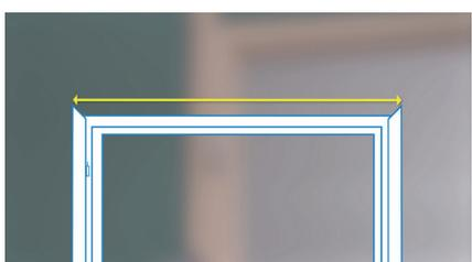
Pour effectuer la coupe du champlat horizontal, mesurez la distance entre les deux plus grandes hauteurs des champlats verticaux.
