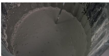
Laissez reposer 3 à 4 minutes afin que les bulles d'air remontent et se dissolvent à la surface.
