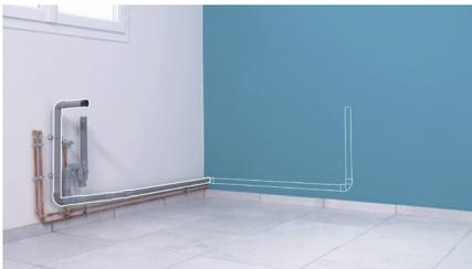
Dans notre cas, le réagencement de l'espace cuisine nécessite de déplacer le système d'évacuation des eaux usées sur l'autre mur.
