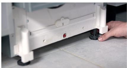
Afin de faciliter sa sortie, baissez la hauteur du lave-vaisselle grâce aux pieds réglables avant et arrière et sortez-le doucement du caisson.
