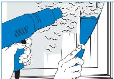
Procéder à un décapage chimique (à l'aide d'un produit décapant) ou thermique (à l'aide d'un décapeur à air chaud).
