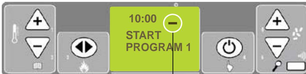
Si ce segment noir n'est pas allumé à l'écran au niveau du symbole de l'horloge, il sera quand même possible d'effectuer la programmation. Pour le faire fonctionner, voir le chapitre consacré au réglage du jour en cours, (MENU 01 RÉGLAGE HORLOGE) car la valeur doit être différente de OFF.
