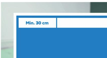
Avant de commencer l'assemblage des lames, assurez-vous que la dernière lame de la première ligne mesurera minimum 30 cm de long.
